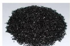
經過精選、破碎、篩選的過程製成，含碳量高、顆粒粗糙表面平滑且質地堅硬，機械強度高，耐磨損，孔隙率大，化學性質穩定能耐酸鹼，亦適合用於酸鹼之過濾。此外，無煙煤濾料不含二氧化矽，因此亦適用於鍋爐用水之過濾使用。
